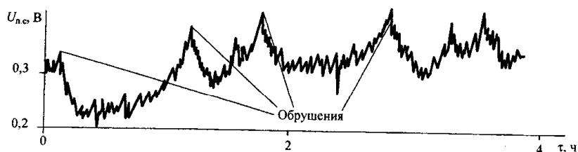
Рис.2. Изменение U_{п.с} фосфорной печи при обрушениях шихты
