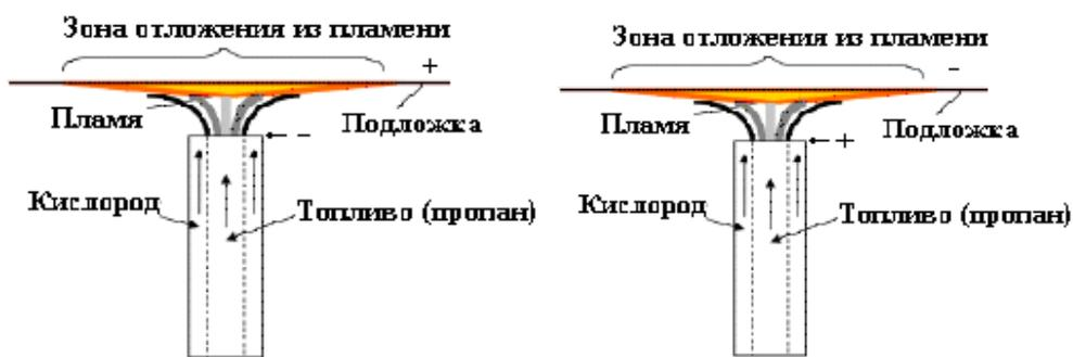
Рисунок 3 - Схематическое изображение подачи электрического поля
